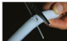
Используя ножницы или нож, сделайте надрез на лицевой поверхности оболочки.
